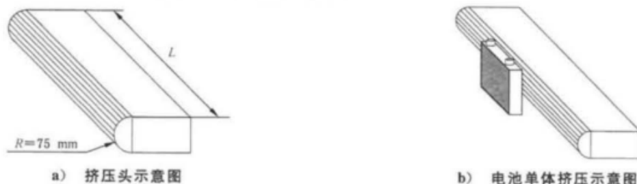
图 2 挤压头和电池单体挤压示意图
