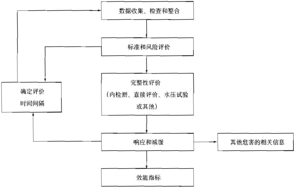
图 A.2 针对内腐蚀危害规定的完整性管理方案（简要流程）
